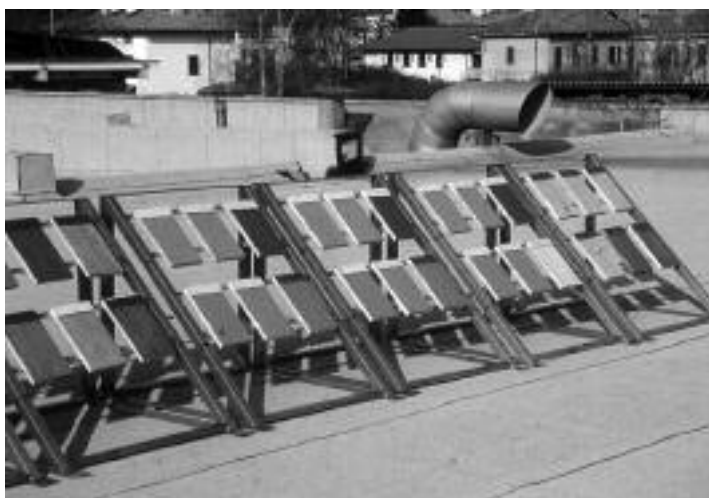
Fig. 9. Ricerca sperimentale sulla durabilità di sistemi di protezione del legno. I provini vengono esposti all'esterno inclinati di 45° e rivolti a sud per un periodo di tre anni. Primi dati significativi sulla durabilità di questi tipi di prodotti sono
